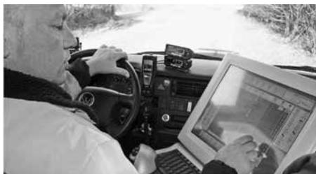
Zu diesem Zweck durchfährt das Erfassungsfahrzeug – deutlich sichtbar durch Warnleuchten und Sicherheitszeichen – im Schrittempo die Straßen. Dadurch, dass alle relevanten Daten überwiegend bereits während der Befahrung registriert werden,
